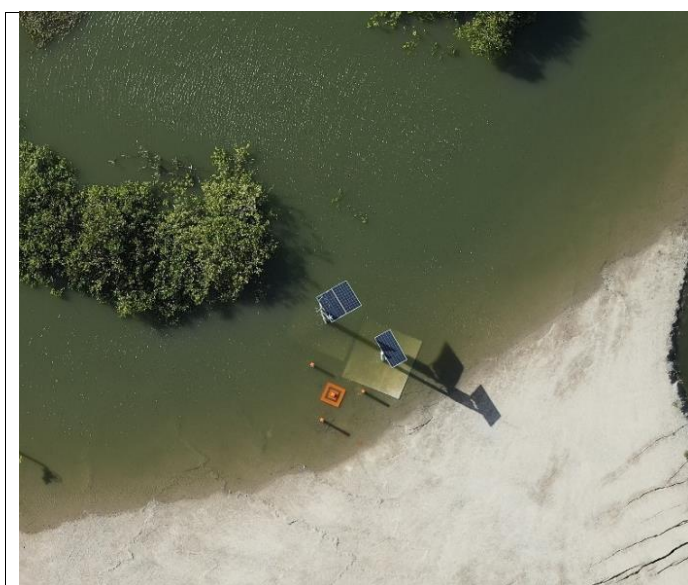
Figura 01: DGPS e estruturas de apoio submersas.
